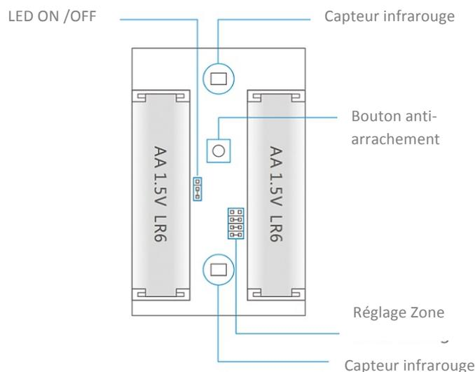
**Détecteur infrarouge** : il détecte les rayons infrarouges émis par les mouvements corporels, prière de ne pas toucher et maintenir propre.
