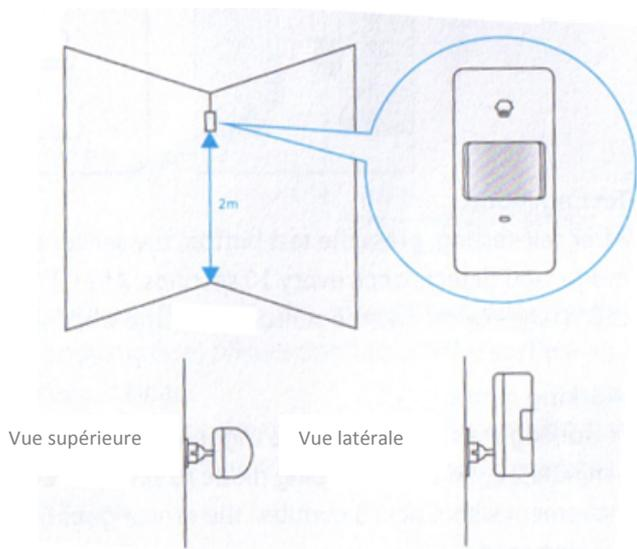
Fixer le crochet au mur à l'aide de vis, et attacher le détecteur au crochet. Ajuster la hauteur d'installation du crochet afin de modifier la distance et l'angle de détection. Il est recommandé de l'installer à 2 mètres du sol.
