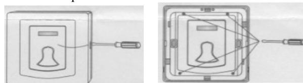
Ôter ces quatre vis puis procéder au remplacement des batteries, en respectant le sens positif/négatif.
