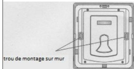
Insérer une vis dans le trou de montage et fixer au mur la base de la sonnette
